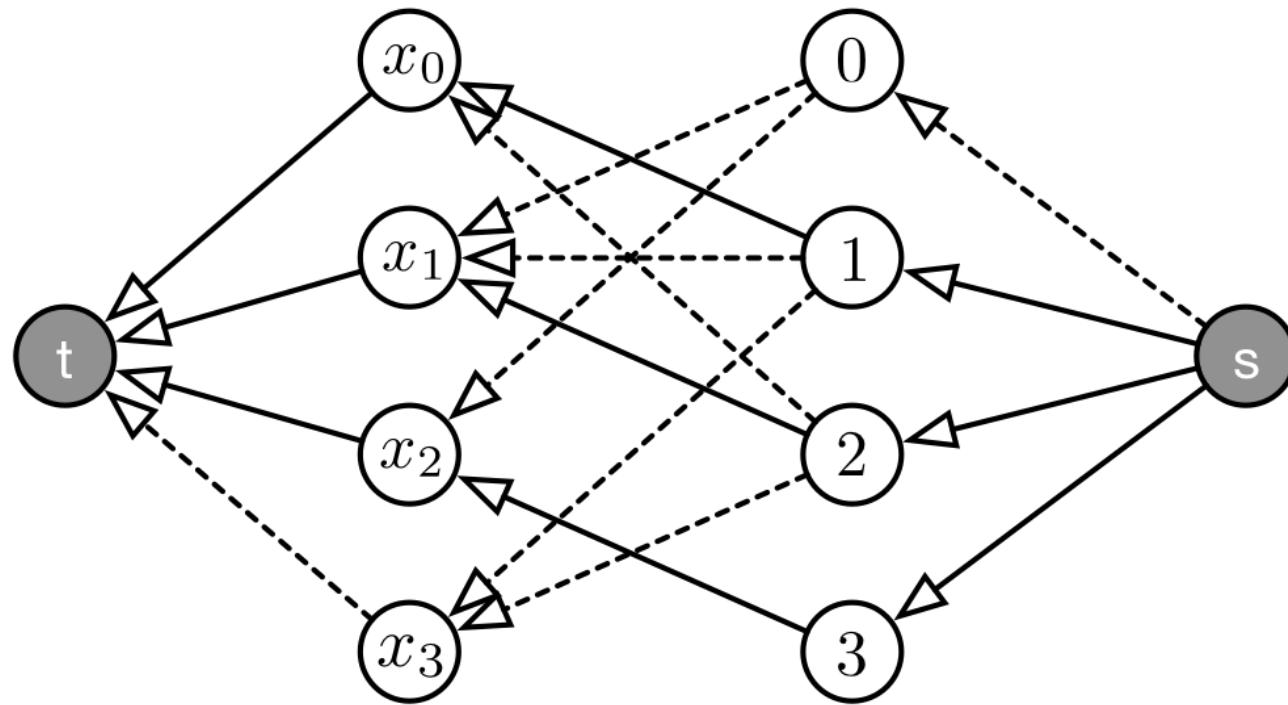
Sia dato questo grafo dei valori per il propagatore basato sul flusso del vincolo **ALLDIFF**. Gli archi non tratteggiati sono attraversati da una unità di flusso.
